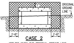
APPLIES WHEN THE ORIGINAL GROUND LINE IS MORE THAN 1 FT. ABOVE THE BOTTOM OF THE BOX CULVERT.
