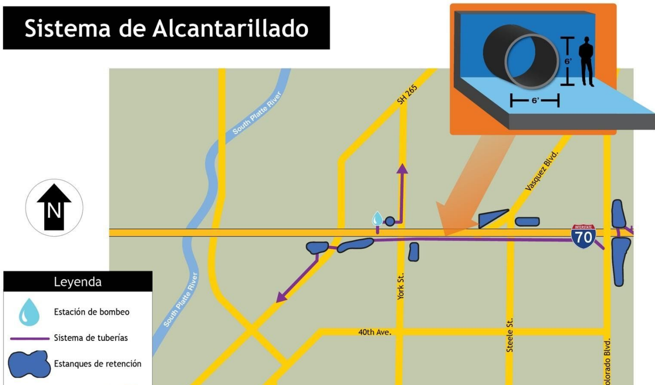
El sistema de drenaje para la I-70 es una combinación de tuberías subterráneas y estanques de retención.
