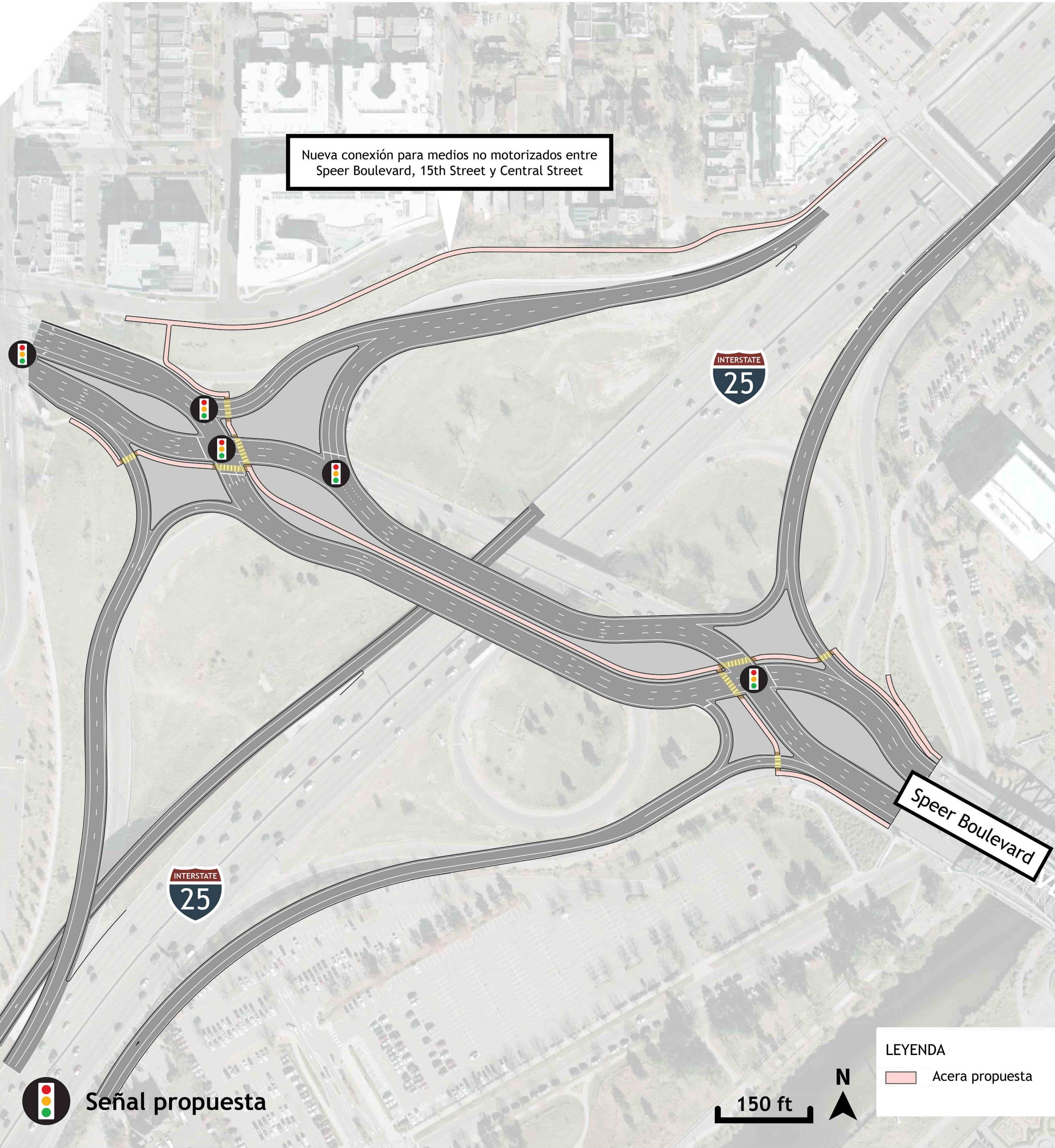
Mapa que demuestra la alternativa de configuración del diseño de diamante divergente cerca del intercambio de la I-25 y 23 Avenue.
