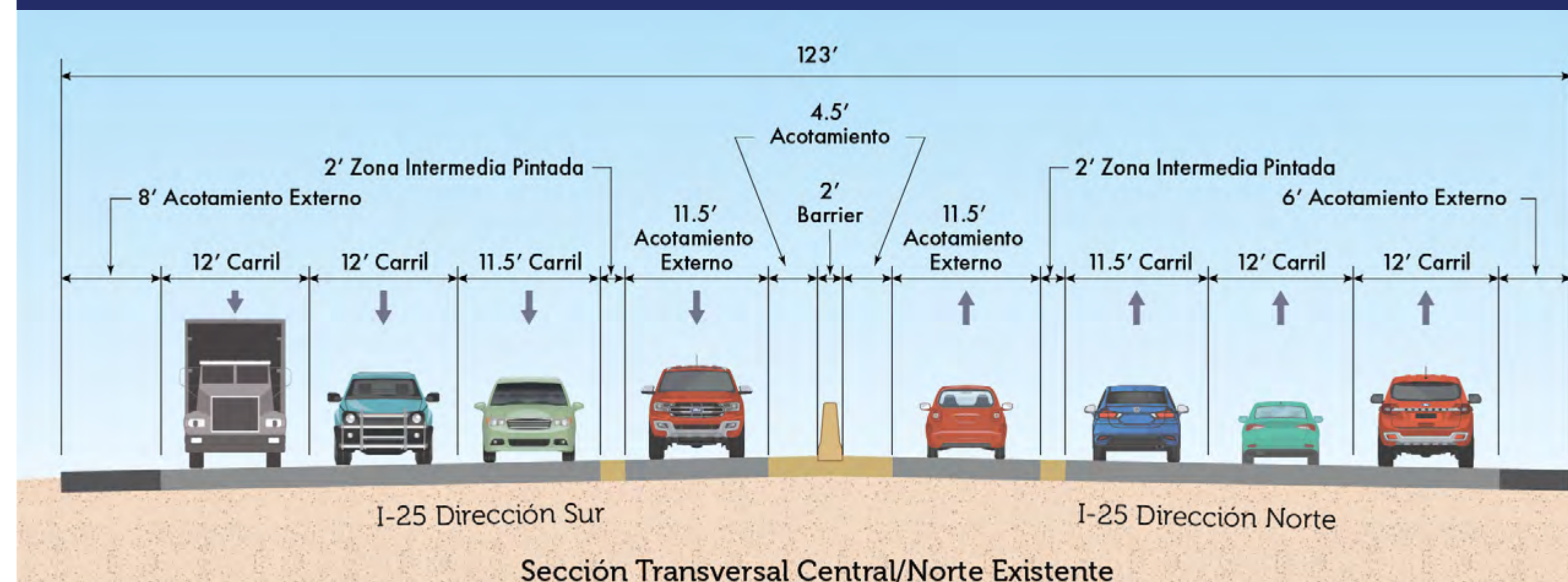
Sección transversal central/norte existente
