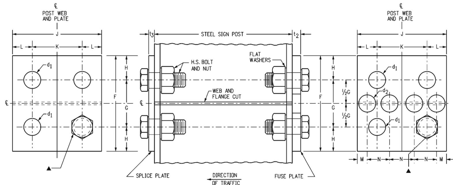
TYPICAL FUSE AND SPLICE PLATE HINGE DETAILS
