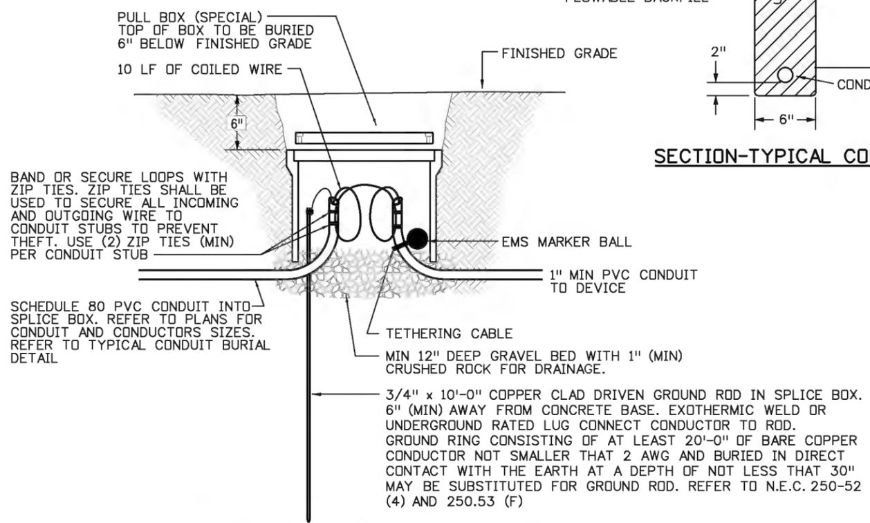
**BURIED SPLICE BOX WITH EMS MARKER BALL DETAIL**
