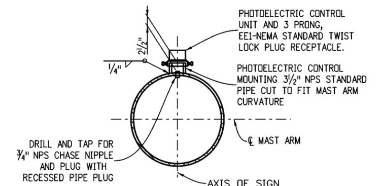
**PHOTOELECTRIC CONTROL DETAILS**
