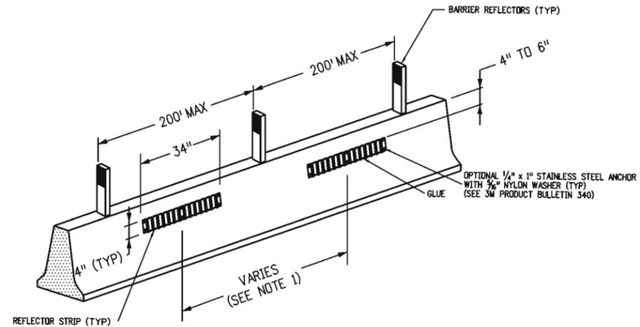
**TYPICAL INSTALLATION DETAIL FOR GUARDRAIL TYPE 3**
