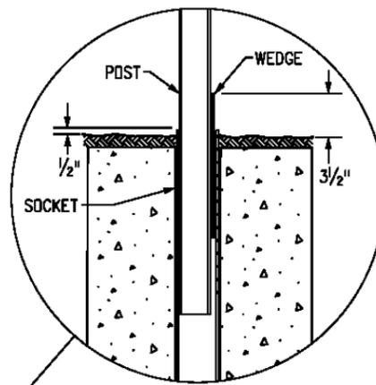
NOTE: WEDGE SHALL BE INSTALLED ON SIDE OF POST FACING TRAFFIC.
