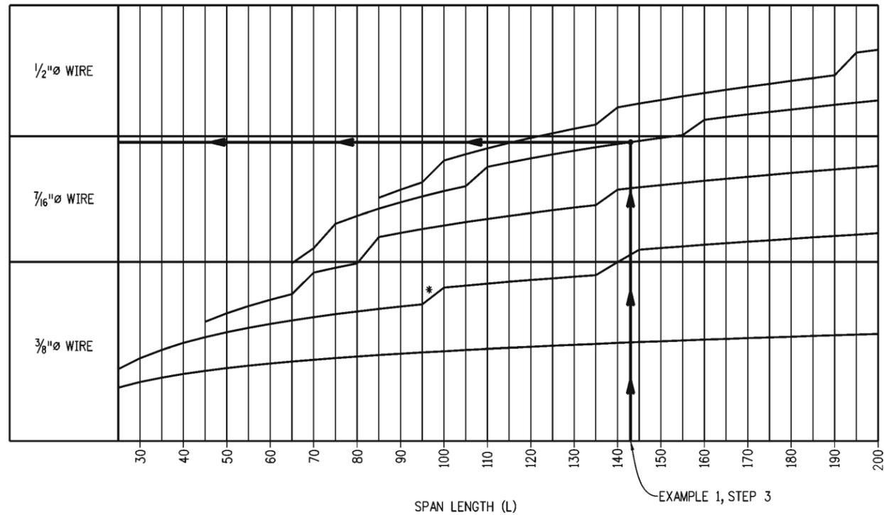
SINGLE SPAN STRAIN POLE SELECTION CHART
