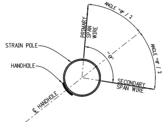
**SPAN WIRE ORIENTATION**
