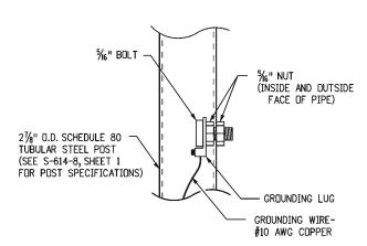
GROUND WIRE/PIPE CONNECTION DETAIL
