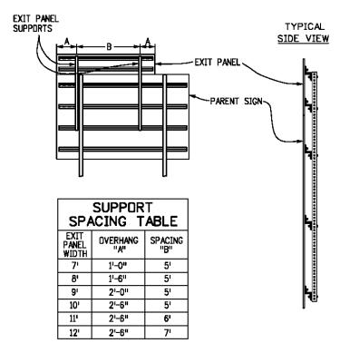
TYPICAL EXIT PANEL INSTALLATION FOR GROUND SIGNS
