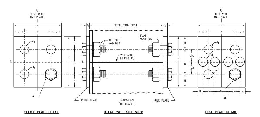
TYPICAL FUSE AND SPLICE PLATE HINGE DETAILS
